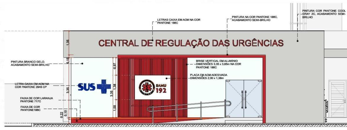
BRISE VERTICAL EM ALUMÍNIO DIMENSÕES 3.35m x 3.85m na cor pantone 186C
