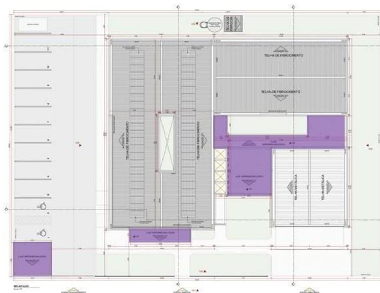
Para a execução da inclinação da laje e proteção física da impermeabilização foi considerado o serviço de contra piso com espessura de 3cm em toda a área de laje impermeabilizada, em ambos os serviços a área considerada foi a mesma da área de LAJE IMPERMEABILIZADA, ou seja, igual a **100,31m<sup>2</sup>**.
